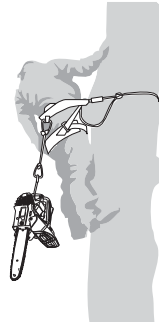
Fig. 48 exemple d'attache d'une tronçonneuse d'élagage en hauteur au point central arrière du harnais
